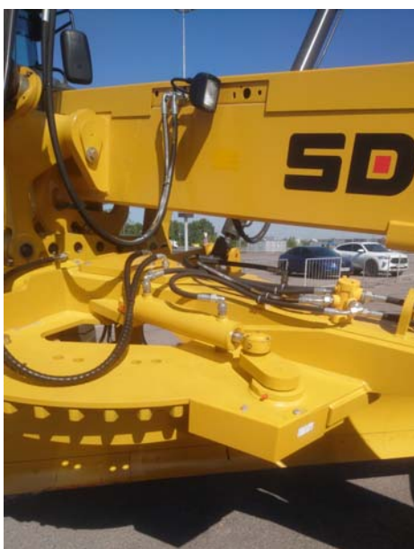
Рис. 4. Механизм поворота отвала автогрейдера серии G китайской фирмы SDLG
