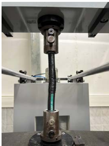
Рис. 2. РВД в процессе испытаний на машине УТС 110М-50
