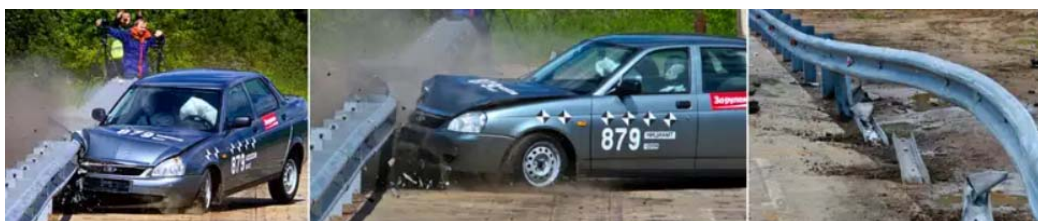
Рис. 4. Столкновение автомобиля с типовым барьерным ограждением на дорогах II категории
