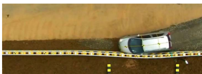
Рис. 5. Столкновение автомобиля с роликовым барьерным ограждением
