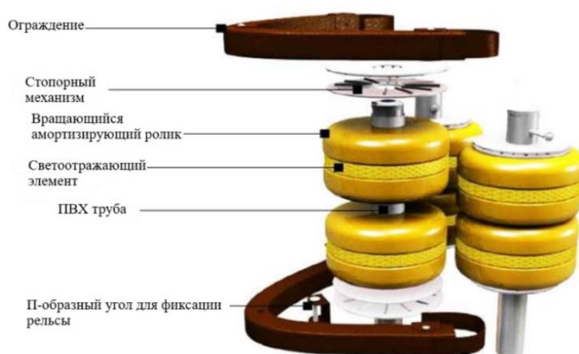
Рис. 2. Устройство роликового ограждения
