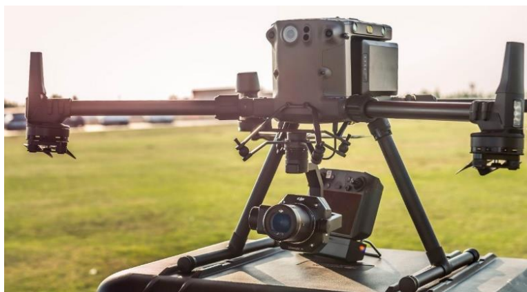
Рис. 1. Дрон DJI Matrice 300 RTK с полезной нагрузкой Zenmuse P1 Источник фото: https://aeromotus.ru/uavs-in-geodesy-opportunities-and-prospects/
