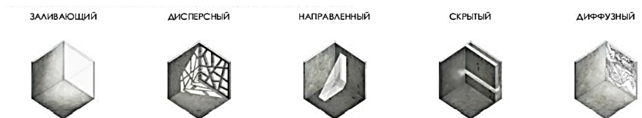
Рис. 11. Способы прохождения естественного света через оболочку здания.
