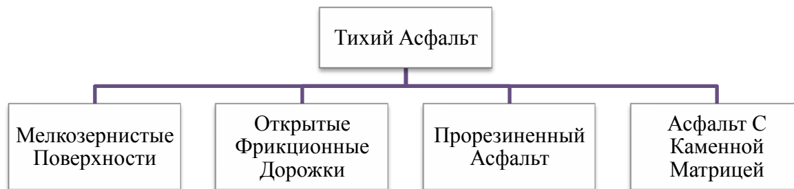
Рис. 3. Разновидности тихого асфальтового покрытия
