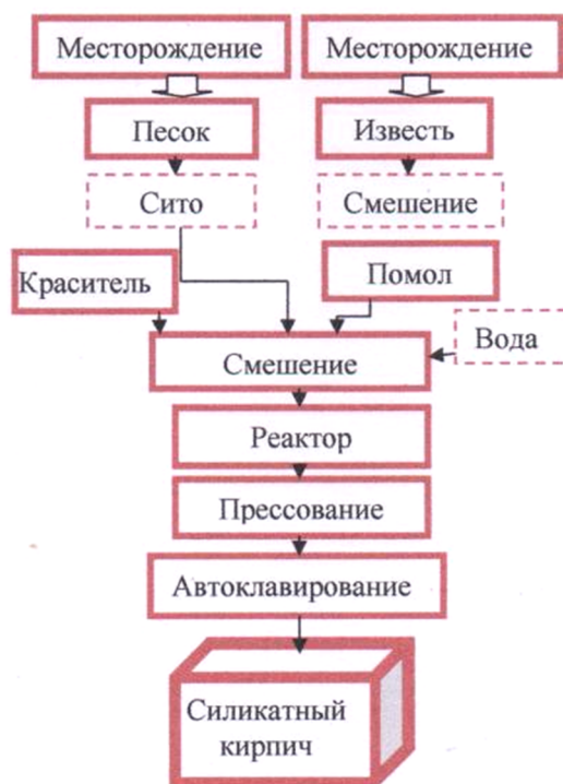
Рис. 1. Блок - схема производства силикатного кирпича
