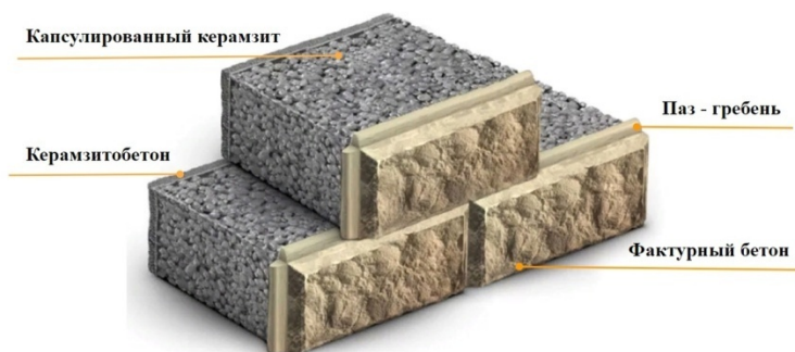
Рис. 1. Конструкция блока Балаева
