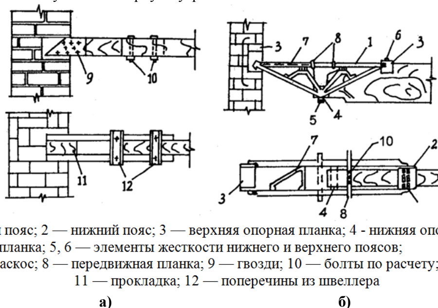
Рис. 3. Усиление техбалок: а) накладками; б) прутковыми протезами
