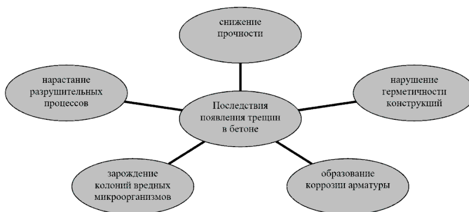
Рис. 1. Последствия от трещин в бетоне
