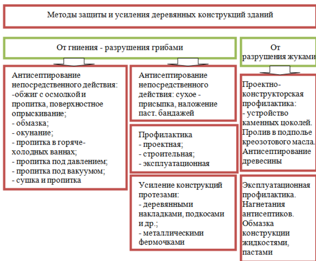
Рис. 1. Методы усиления стройконструкций из дерева
