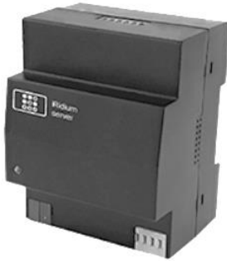
Рис. 4. Аппаратная реализация iRidium server
